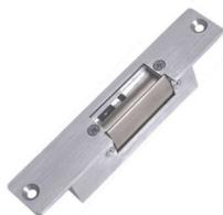
Dispositivo di chiusura elettrico progettato per essere installato su telai di porte, compatibile con serrature meccaniche tradizionali. L'incontro elettrico consente l'apertura remota della porta mediante un impulso elettrico, che sblocca temporaneamente la serratura, permettendo l'accesso senza la necessità di girare.
