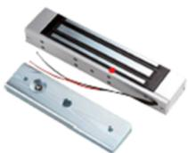
Sistema di chiusura basato su un potente elettromagnete, ideale per porte o accessi dove è richiesta una soluzione sicura e senza parti meccaniche mobili. La chiusura magnetica mantiene la porta bloccata fino a quando viene disattivata elettronicamente, garantendo un'elevata resistenza allo scasso.
